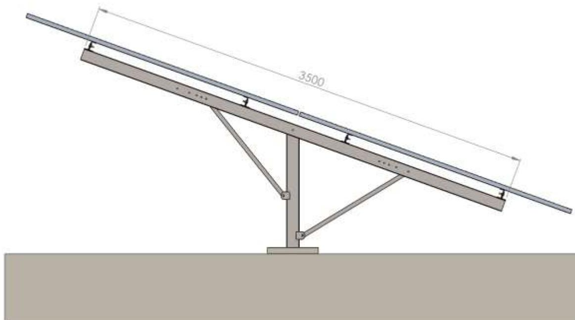
**Figura 16** - Vista Lateral da Montagem da Estrutura de Solo Baixa Monoposte 02 Módulos.
