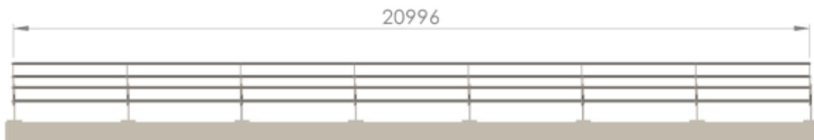
**Figura 6** – Comprimento da Estrutura de Solo Baixa Monoposte p/36 Módulos
