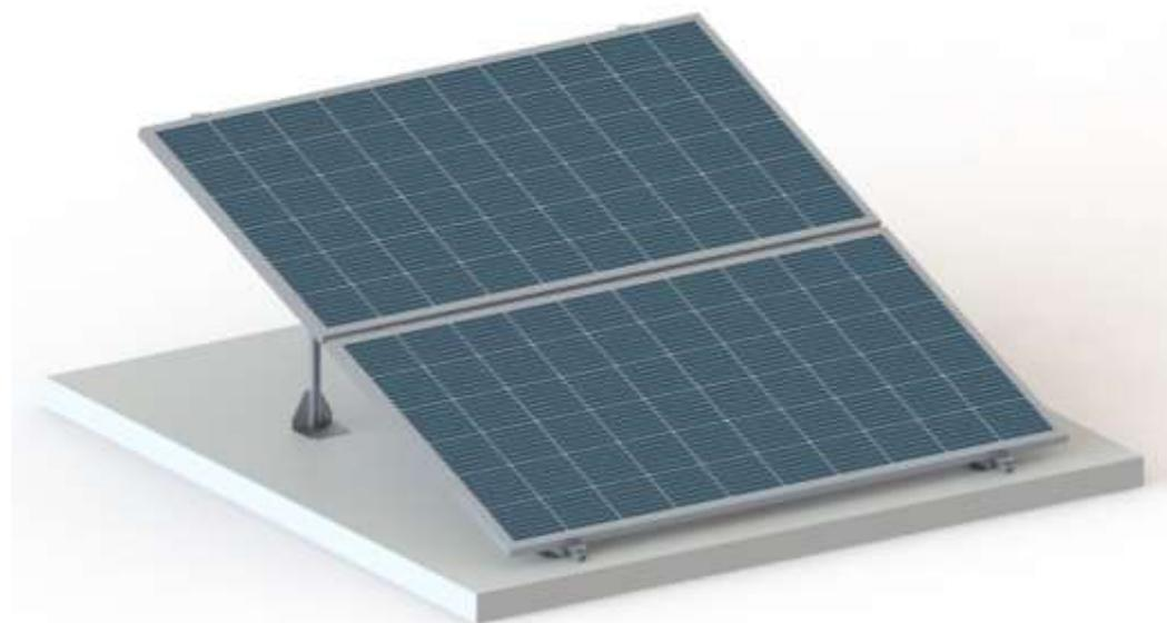
**Figura 2** - Perspectiva da Montagem da Estrutura para Laje 02 Módulos.
