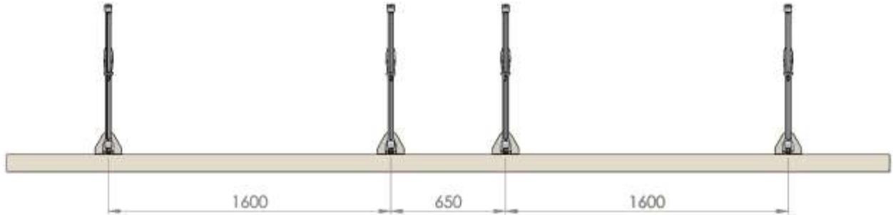
**Figura 11** - Distância entre os suportes de laje.
