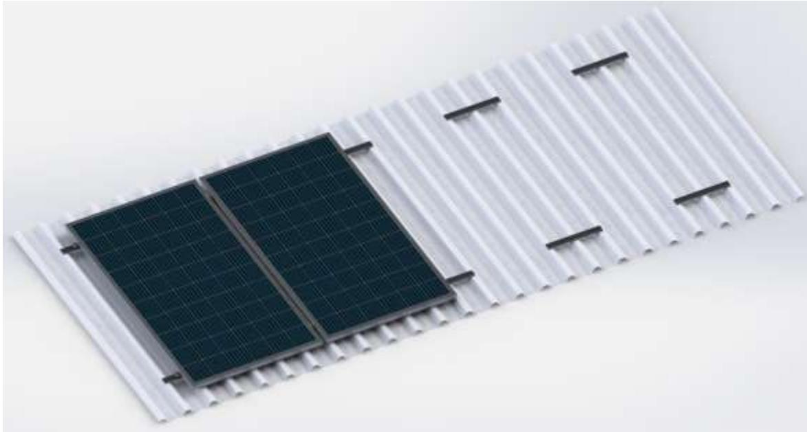
**Figura 8** - Montagem do 2º módulo
