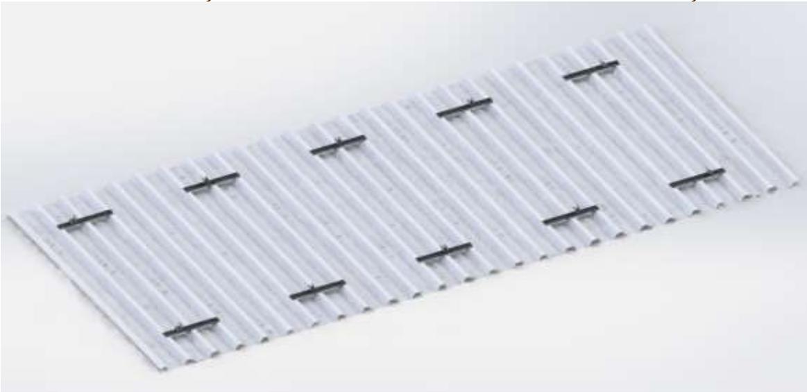
**Figura 1** - Montagem do Suporte de Fixação para Telhado Trapezoidal Perfil Direto para 4 Módulos – Sem os módulos
