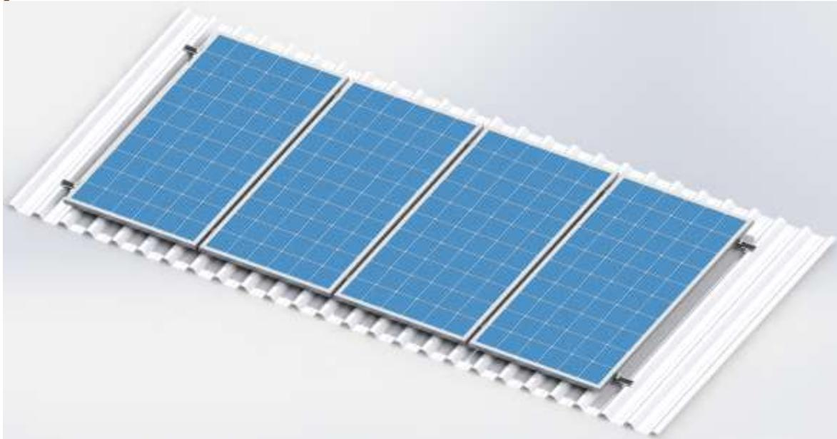
**Figura 12** – Estrutura Montada
