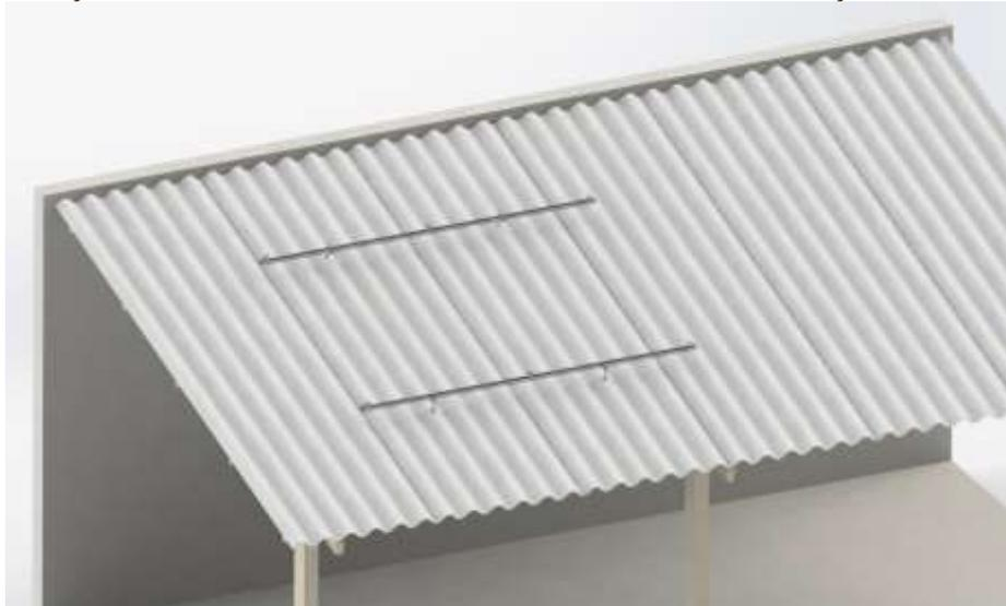
**Figura 1** - Montagem do Suporte de Fixação para Telhado Fibrocimento com Parafuso Estrutural para 2 Módulos – Sem os módulos.
