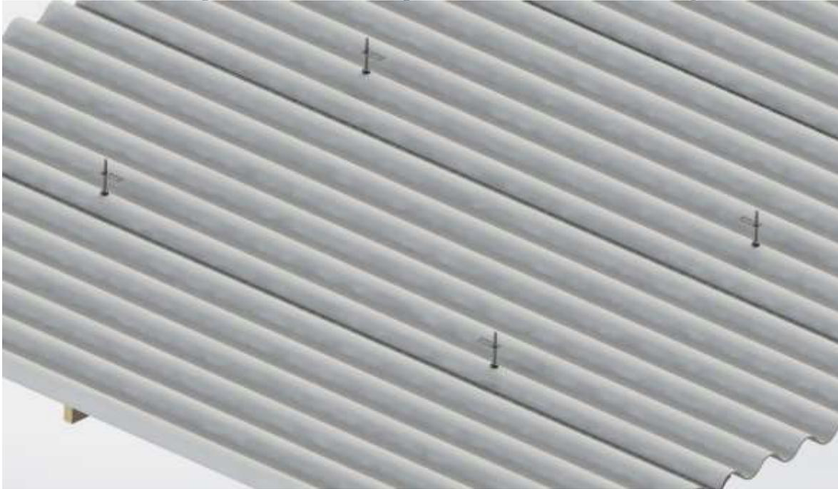
**Figura 4** - Sentido dos parafusos estruturais
