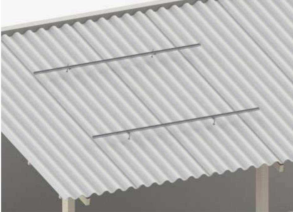
**Figura 6** – Montagem dos perfis de alumínio
