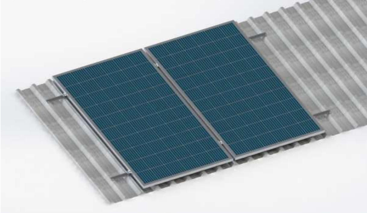
**Figura 8** – Montagem do 2º módulo
