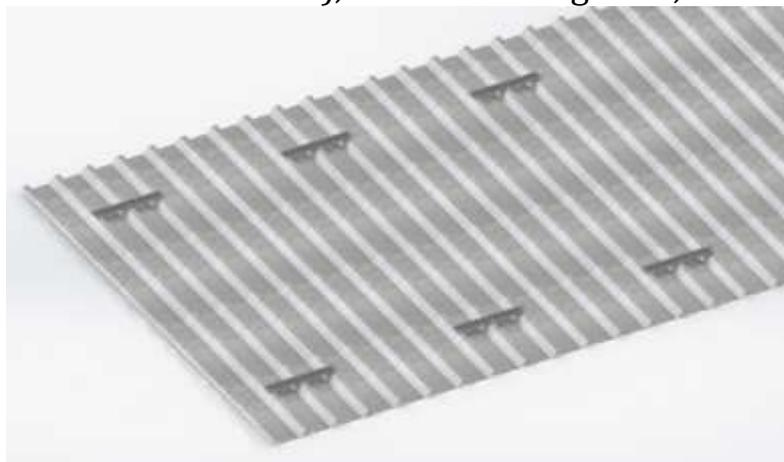
Figura 3 - Posição dos Suportes na Telha Trapezoidal
