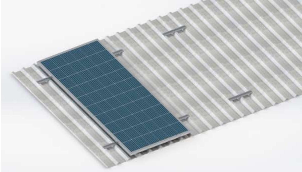
**Figura 6** - Montagem do 1º módulo
