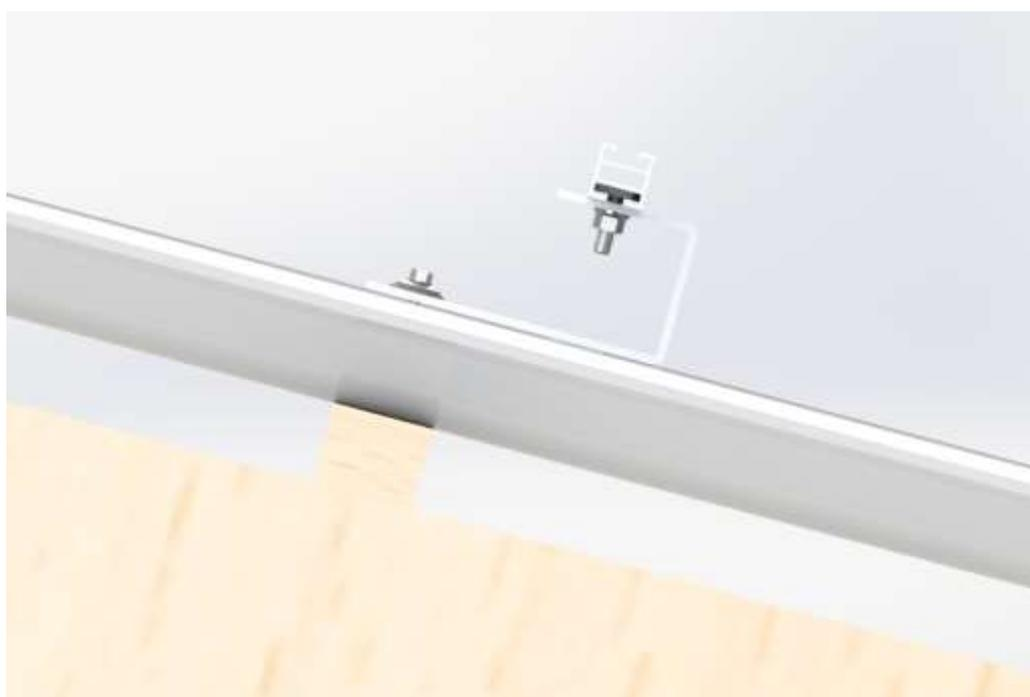
**Figura 9** – Montagem do perfil de alumínio
