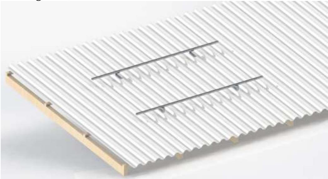
**Figura 4** – Posicionamento dos suportes “J”
