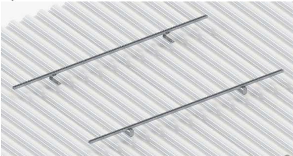
**Figura 8** – Montagem dos perfis de alumínio
