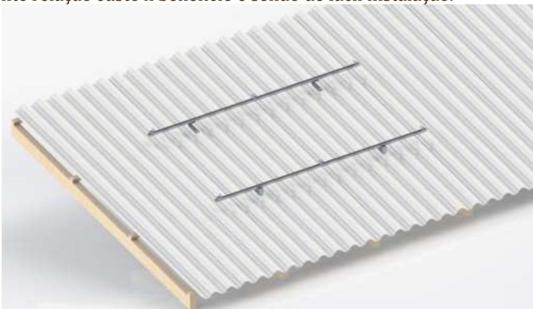
**Figura 1** - Montagem do Suporte de Fixação para Telhado Fibrocimento para 2 Módulos – Sem os módulos.
