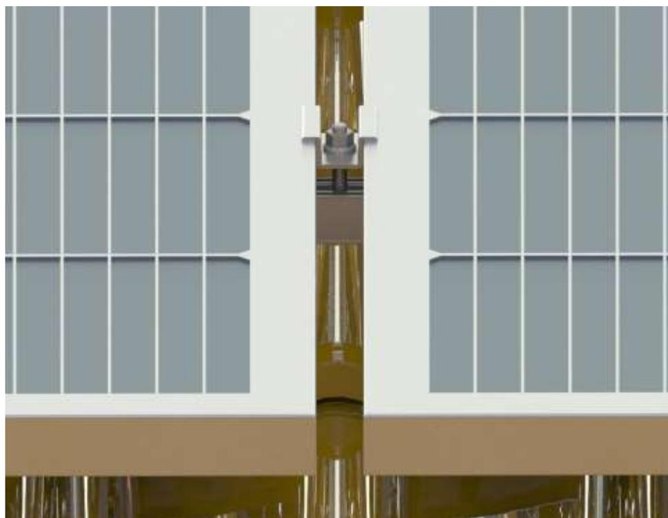
**Figura 15** – Montagem da fixação intermediária
