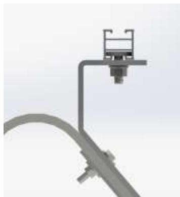
**Figura 7** - Detalhe de montagem do perfil de alumínio
